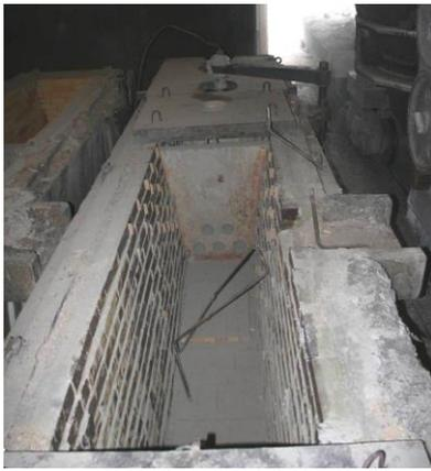
Рисунок 4. Экспериментальный промковш с камерами для плазменного подогрева
