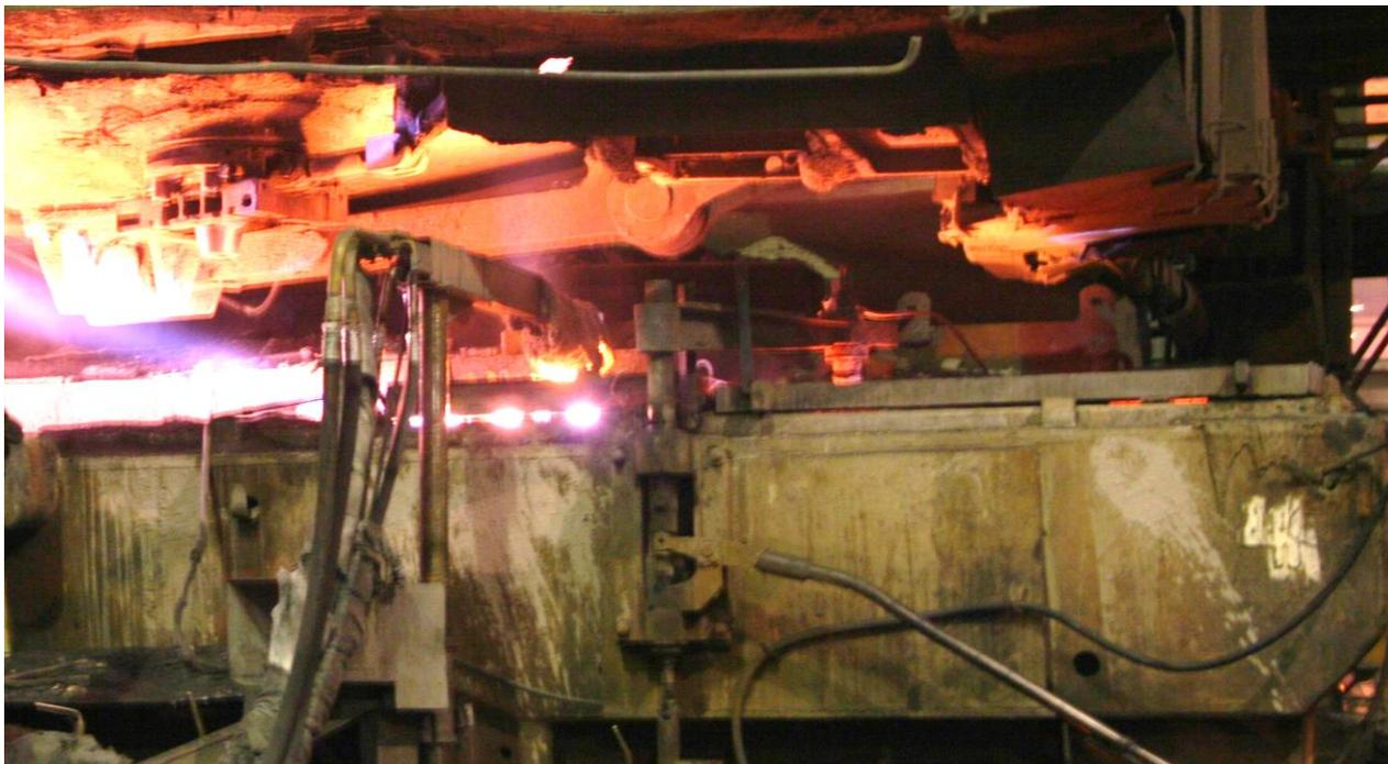
Рисунок 1. Испытания плазменного подогрева в промковше
